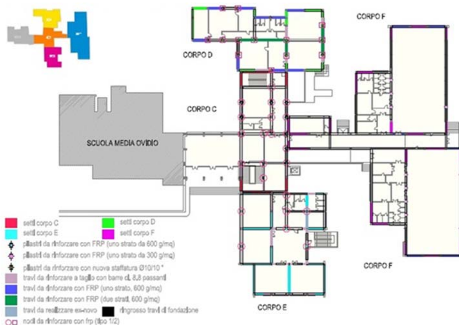
Figura 1: Schema interventi strutturali
